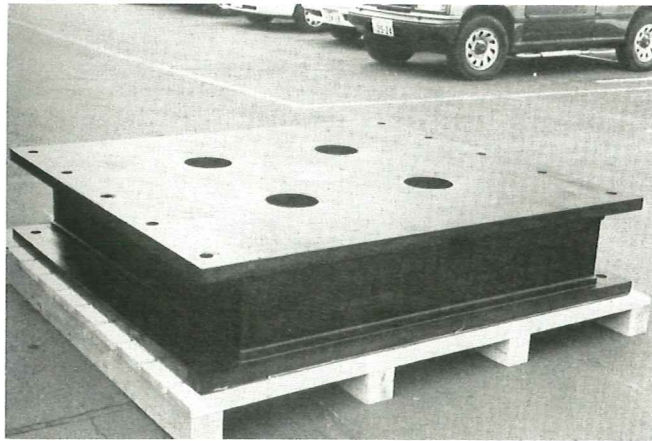
Figura 1.1 Apoyo laminado con elementos de plomo (LRB) en proceso de manufactura (Shioi et al, 1994)
