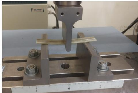
**Figura 4.** Caracterización de flexión de perfiles obtenidos
