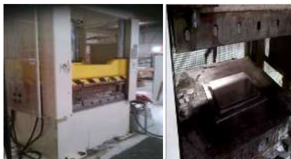
Figura 17. Moldeo del laminado de composites en prensa.
