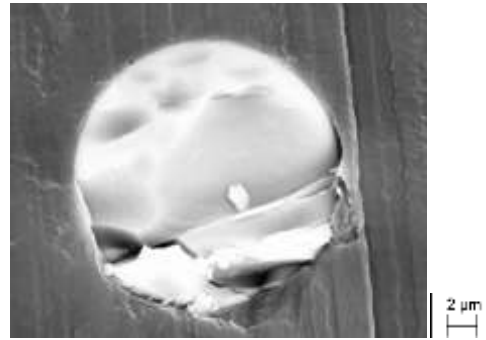
Figura 5. Ejemplo de Interfase resina –matriz en formulación prototipo estudiada con buena adherencia
