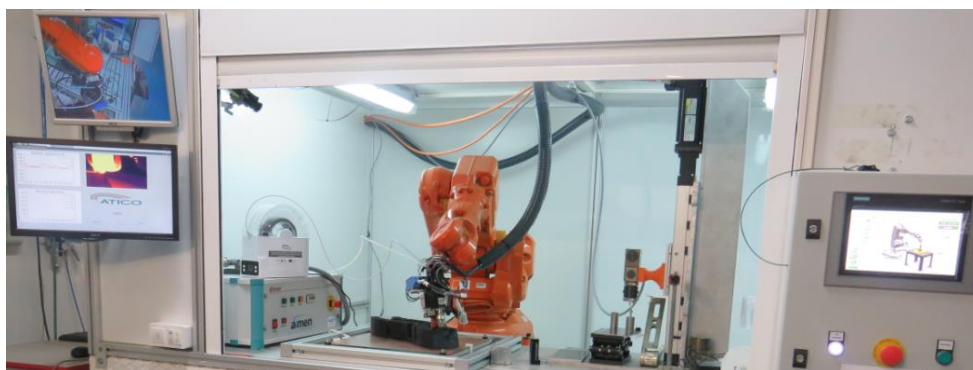
Figura 1. Celda desarrollada de impresión 3D robotizada.
