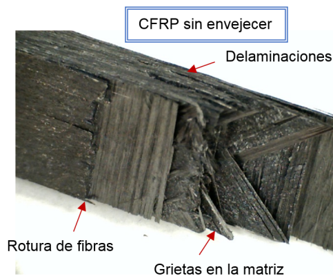
Figura 3. Modos de fallo observados en probetas CFRP de configuración cuasi-isótropa [0/90/\pm 45]_{2s} sin envejecer.
