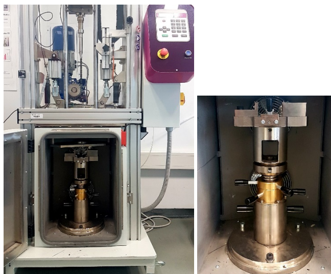
Figura 1. Columna de impacto CEA 9340 y accesorio para Charpy
