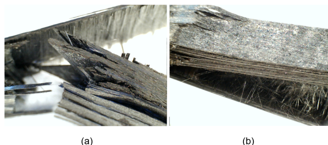
Figura 4. Modos de fallo observados en probetas CFRP de configuración cuasi-isótropa [0/90/\pm 45]_{2s} . a) 190°C, 3 días; b) 230°C, 20 días
