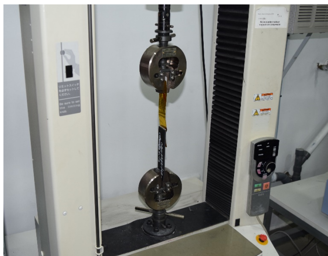
Figura 5. Ensayo de pelado a tracción a 180°
