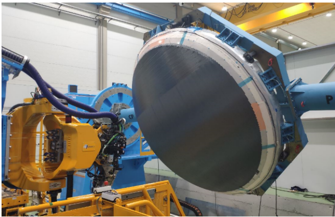
Figura 10. Encintado automático de fibra seca.
