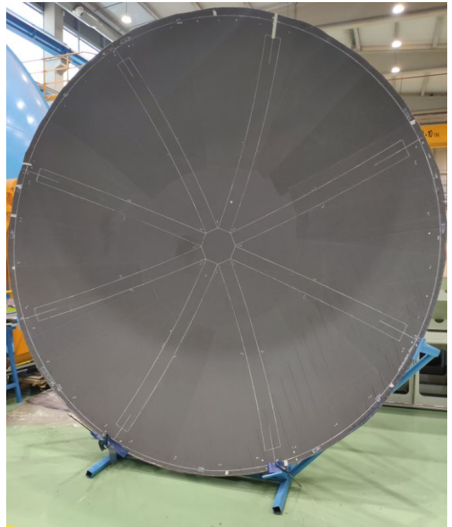
Figura 11. Piel de fibra seca mediante infusión LRI.
