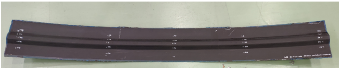
Figura 9. Rigidizador fabricado mediante infusión LRI.
