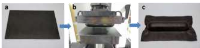
Figura 3. Laminado dinámico de fibra de carbono termoconformado en molde de semitubo
