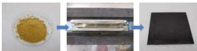
Figura 7. Placa de resina epoxi dinámica fabricada a partir de resina recuperada del reciclado químico.
