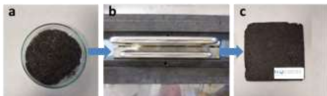
Figura 8. Reciclado mecánico de laminado dinámico de fibra de carbono (a) material triturado, (b) prensado, (c) laminado de segunda generación
