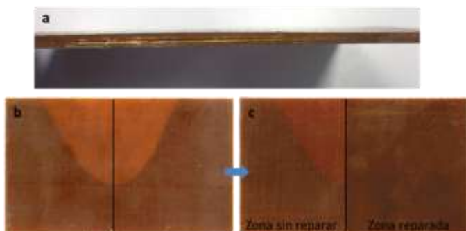
Figura 4. Laminado dinámico de fibra vidrio (a, b) delaminado y (c) reparado parcialmente aplicando presión y temperatura.
