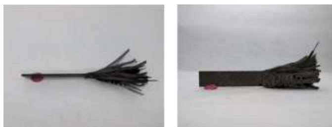
Figura 6. Disolución parcial de la resina en un laminado dinámico de fibra de carbono sumergido parcialmente en un agente reductor específico.
