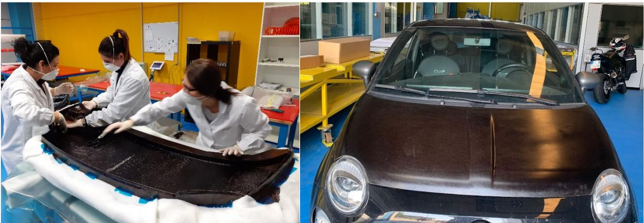
**Figura 7.** a) Diseño y actividades de validación sobre el demostrador © Stellantis (reproducido con permiso), b) laminación del prototipo y c) demostrador final montado en el vehículo.
