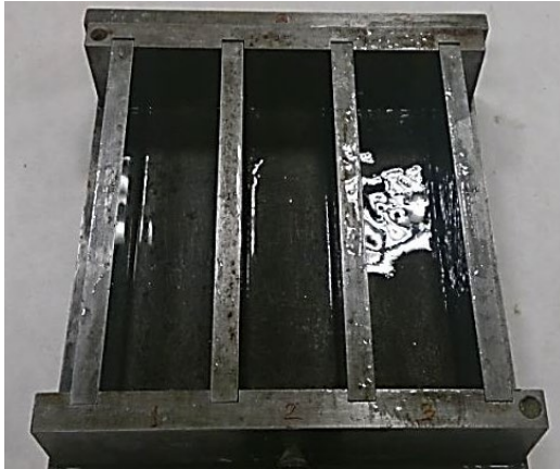
Figura 1. Molde estandarizado impregnado con el desencofrante.
