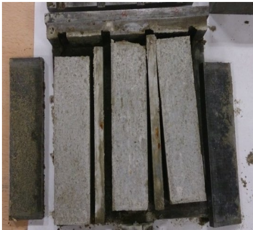
Figura 2. Mortero desencofrado con propiedades hidrofóbicas.
