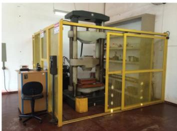
Figura 5. Prensa para la prueba de resistencia a la compresión.
