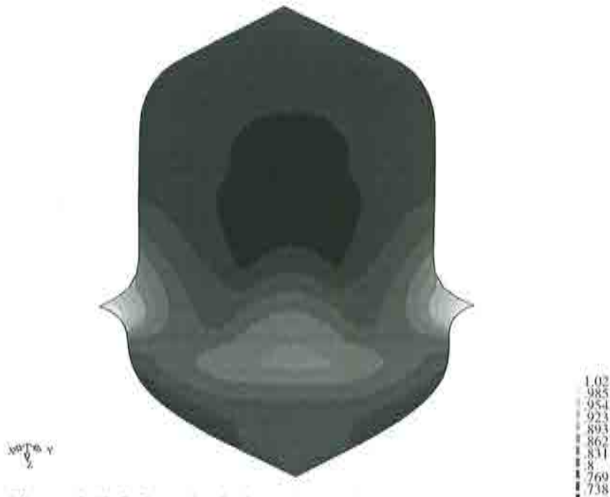
Figura 6.40 Influencia de la anisotropía transversal sobre el espesor. Distribución del espesor final en la lámina para \bar{R}=1.77 , h_{max} = 1.05 y h_{min} = 0.707
