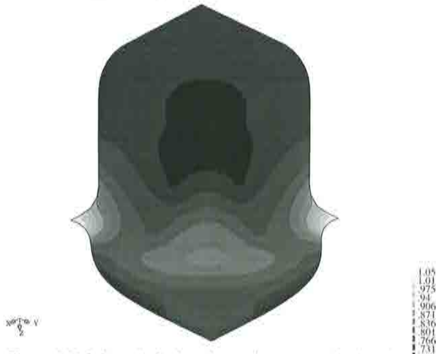
Figura 6.39 Influencia de la anisotropía transversal sobre el espesor. Distribución del espesor final en la lámina para \bar{R}=1.50 , h_{max} = 1.08 y h_{min} = 0.696
