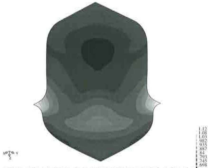
Figura 6.38 Influencia de la anisotropía transversal sobre el espesor. Distribución del espesor final en la lámina para \bar{R}=1.00 , h_{max} = 1.17 y h_{min} = 0.65
