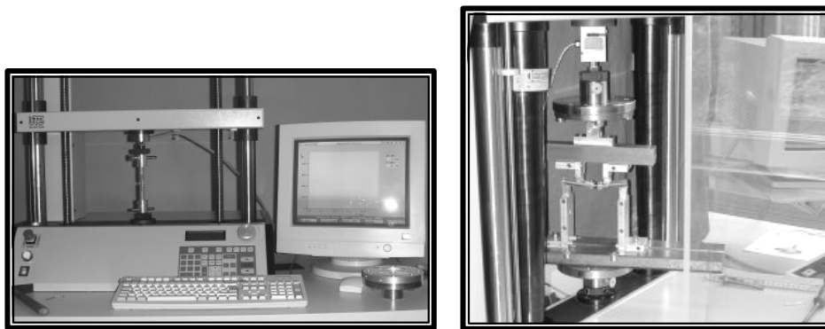
Figura 6. Pruebas experimentales de tensión, torsión y flexión en MTS
