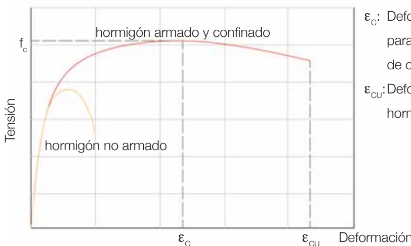
Figura 1.2 Diagrama tensión-deformación del hormigón no armado y de hormigón armado y confinado, obtenido de ensayo de compresión.
