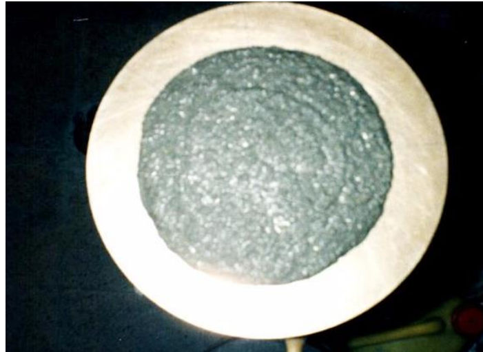
Fotografía 5. Consistencia del mortero para ferrocemento. [Bedoya 96].
