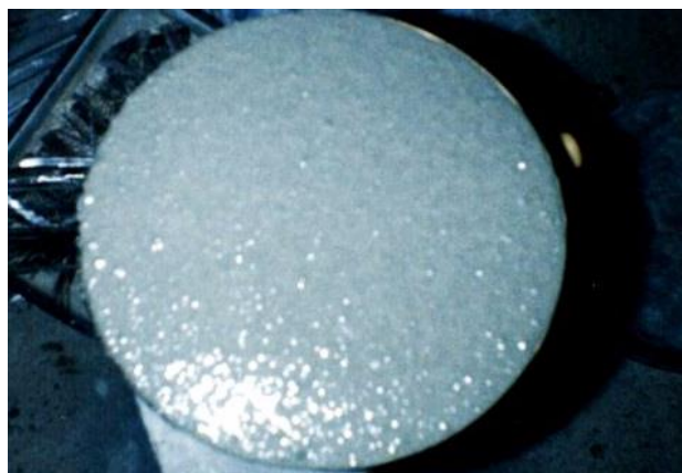
Fotografía 8. Consistencia no deseada del mortero para ferrocemento [Bedoya 96].
