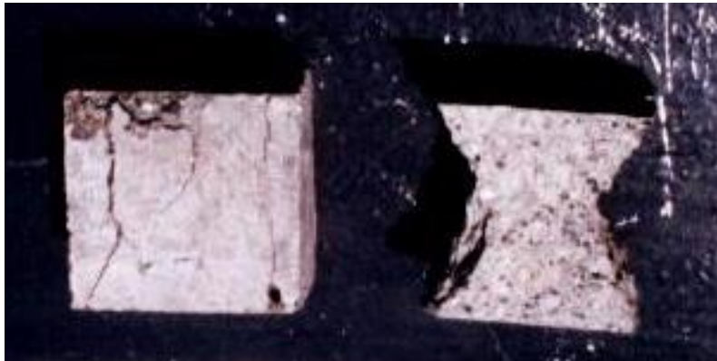
Fotografía 6. Ensayo de resistencia a la compresión [Bedoya 96].
