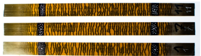
Figura 4. Specimen de tracción con fragmentación debido a película de resina en la intercara.
