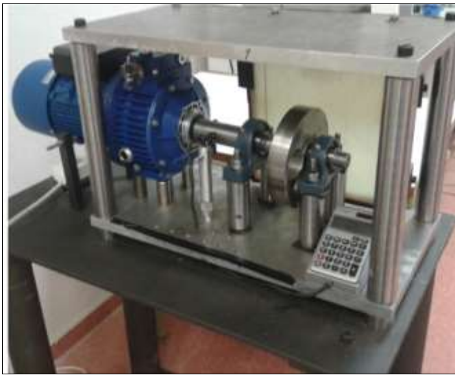
Figura 1. Equipo de reproducción de impactos de slamming.
