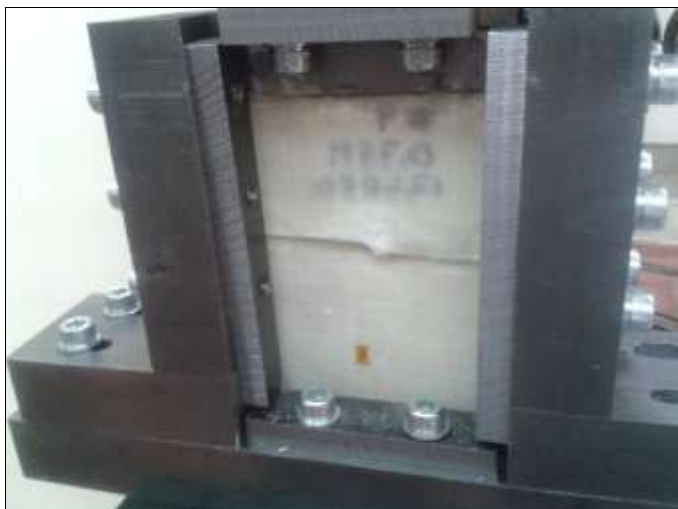
Figura 3. Probeta sometida a compresión restringida tras impacto.
