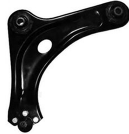
Figura 2. Brazo de control delantero en acero objeto de rediseño
