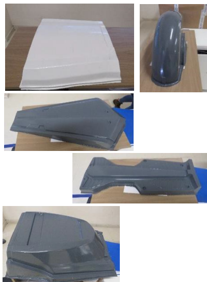
Figura 13. Piezas del chasis fabricadas mediante termoconformado.
