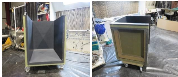
Figura 9. Molde de madera DM Hidrófuga diseñado y fabricado para la obtención del maletero.
