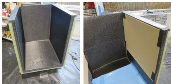
Figura 10. Colocación de las láminas de prepreg de fibra de carbono y del núcleo de PVC para la fabricación del maletero.
