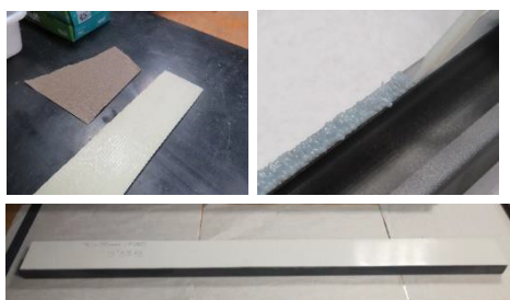
Figura 17. Proceso de unión acero-composite en los perfiles híbridos.
