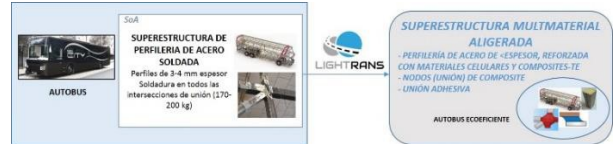
Figura 3. Caso de estudio y estrategia para el desarrollo de una superestructura de autobús aligerada.
