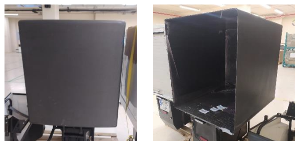
Figura 11. Maletero de material compuesto aligerado fabricado.
