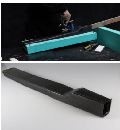
Figura 8. Basculante fabricado en material compuesto.
