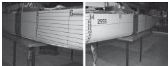
Figura 6.- Modelo a escala 1:60. Disposición de las quillas de balance
