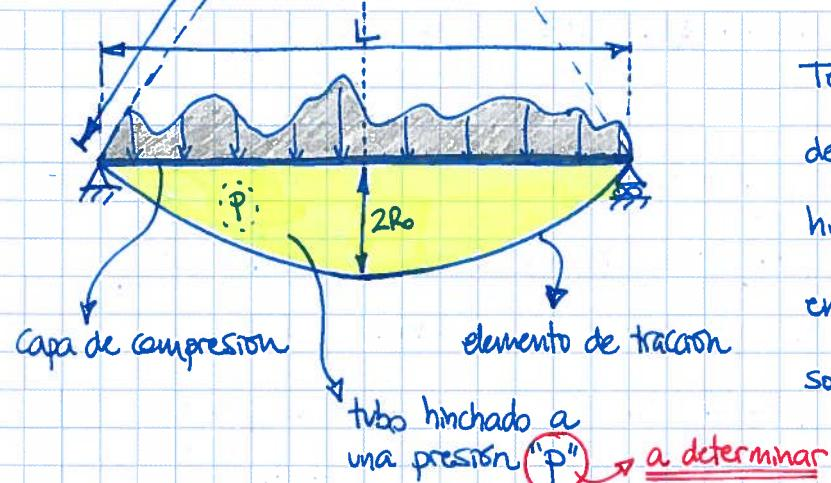
Tenemos una viga Tensairity de longitud  $L$  con forma de huso textil (spindle-shaped) que en el centro tiene un diámetro  $2R_o$ . Sometida a unas determinadas cargas.
