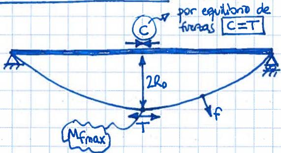
Por una parte el cable tiene que absorber el momento flector máximo que tendremos en el centro de la viga. La tensión será:
