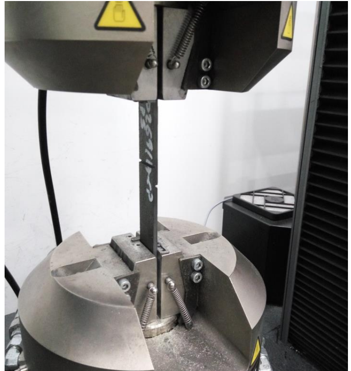
Figura 5. Ensayo mecánico de resistencia a cortadura en uniones a solape simple con incisión
