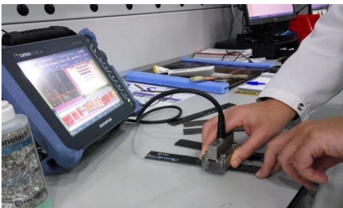
Figura 4. Inspección por ultrasonidos
