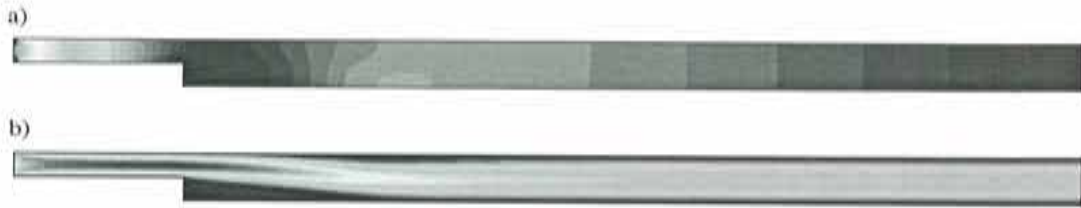
Figura 5.12: Flujo sobre un escalón inverso. Contornos de presión (arriba) y de velocidad (abajo).
