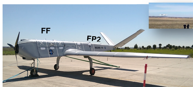
Figura 1. RPAS MILANO con SHM integrado durante las pruebas en tierra. FF / FP2: Fuselaje delantero / posterior. Arriba dcho: MILANO en vuelo
