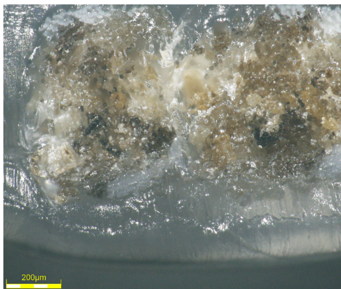
Figura 5. Imagen del anclaje lino-LDPE de la superficie de fractura
