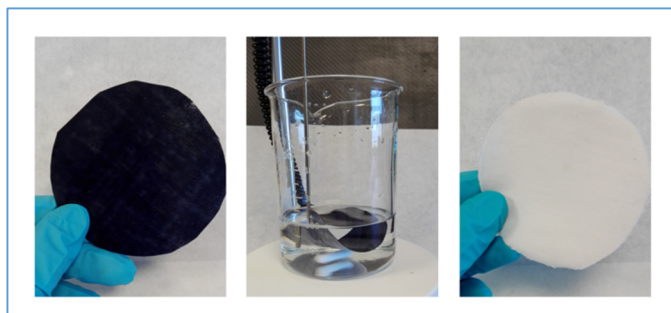
Figura 7. Disolución de composite flexible de resina de poliuretano de un espesor de 0,4 mm.
