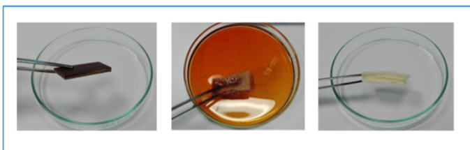
Figura 8. Disolución de composite flexible de resina epox de un espesor de 3 mm.
