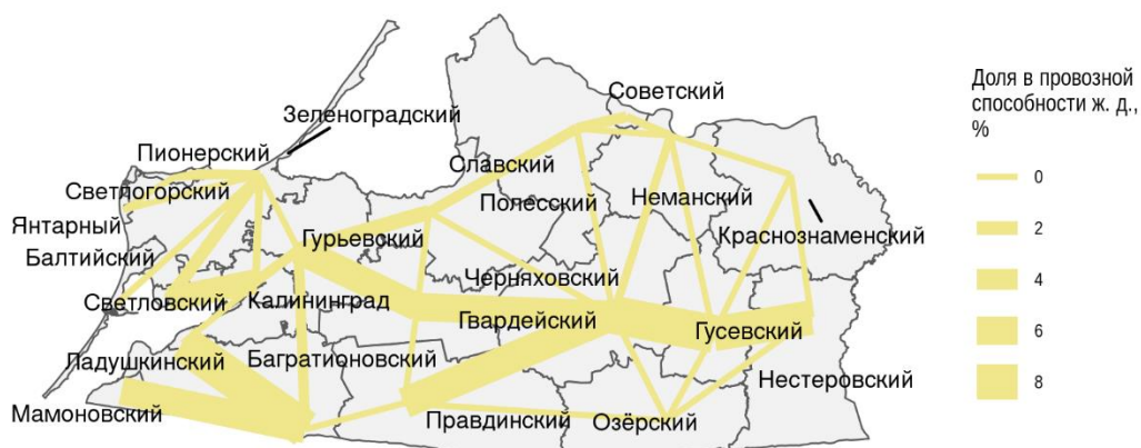
Рисунок 26 — Оценки совокупной провозной способности и железных, и автомобильных дорог между городскими округами Калининградской области
