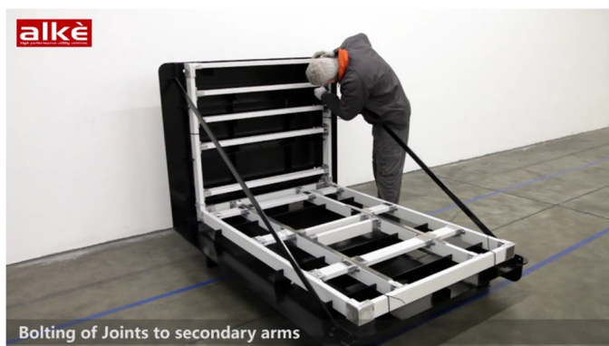
Figura 8. Unión de todos los perfiles para montar la cama del vehículo eléctrico
