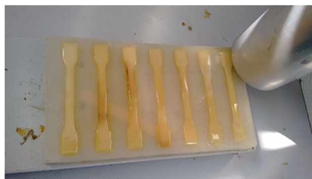
Figura 4. Detalle del curado por MW de las muestras halterio para su posterior ensayo de tracción
