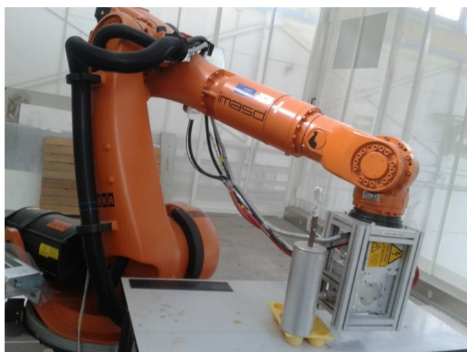
Figura 1. Robot MW compuesto por un magnetrón de 2000W y una antena cilíndrica cuya frecuencia es 2.45GHz y longitud de onda 12 cm (similar a los hornos MWs caseros).
