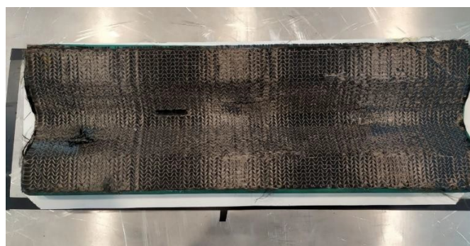
Figura 9 Preforma con defectos superficiales
