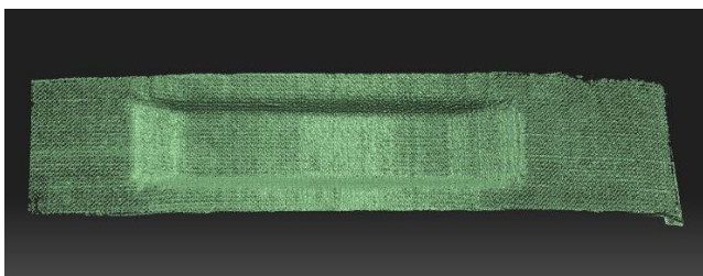
Figura 4 Reconstrucción 3D de la fibra
