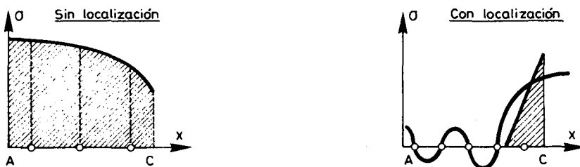
Figura 12. Análisis de la integración de Gauss-Legendre en problemas con endurecimiento y ablandamiento. a) Geometría y estado de deformación. b) Ecuación constitutiva con endurecimiento. c) Ecuación constitutiva con ablandamiento. d) Integración de Gauss-Legendre.
