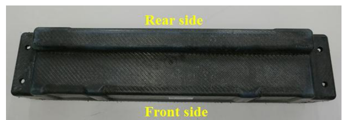
Figura 8. Subframe después del ensayo de fatiga.
