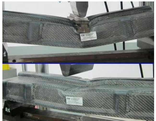
Figura 4. Subframe durante y después del ensayo de flexión.
