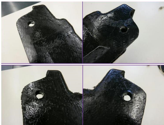
Figura 9. Aspecto de los bushings en las piezas definitivas después del ensayo de fatiga.
