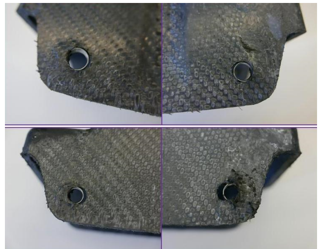
Figura 7. Daños en los bushings (derecha traseros-izquierda delanteros) en las piezas de prueba después del ensayo de fatiga.
