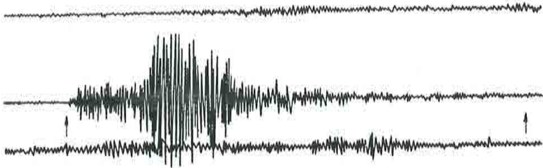
Figura 2.- Sismograma correspondiente a la componente vertical del terremoto acontecido el 12 de Junio de 1982 a las 17 h. 23 m. 52.6 s, localizado en el Pirineo Occidental y registrado en la estación sismográfica de EBR (Ebro)
