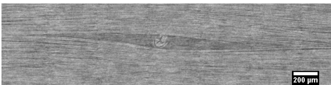
Figura 5. Decohesión entre hilo termoplástico y matriz.
