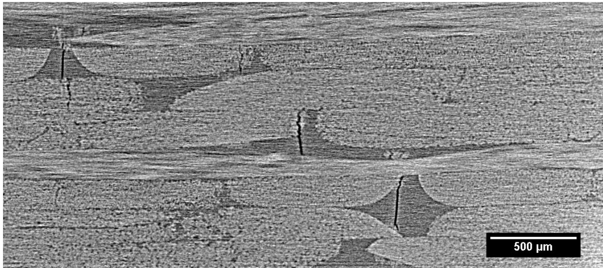
Figura 1. Microgrietas en panel P1 con tejido NCF sometido a 800 ciclos a través del espesor.
