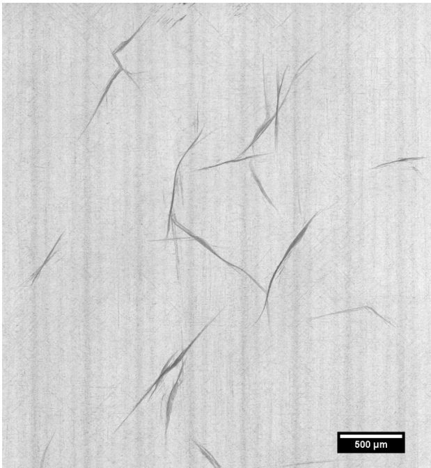
Figura 4. Proyección en Z (dirección fuera de plano) del laminado NCF en el que se observan las direcciones de propagación de las microgrietas.
