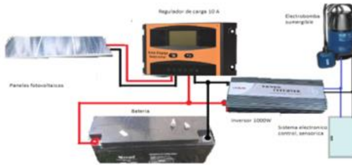
Figura 1. Diagrama energético de riego. Proyecto riego localizado automatizado, alimentado con energías alternativas en parcelas de frutas tropicales, de pequeños productores. Espinal, Tolima, Colombia. 2020. Fuente. Elaboración propia.
