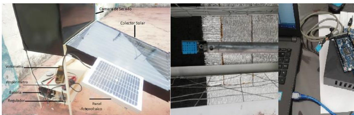
Figura 3. Dispositivos para la medición de variables eléctricas y ambientales. Fuente. Propia de los autores, 2019.
