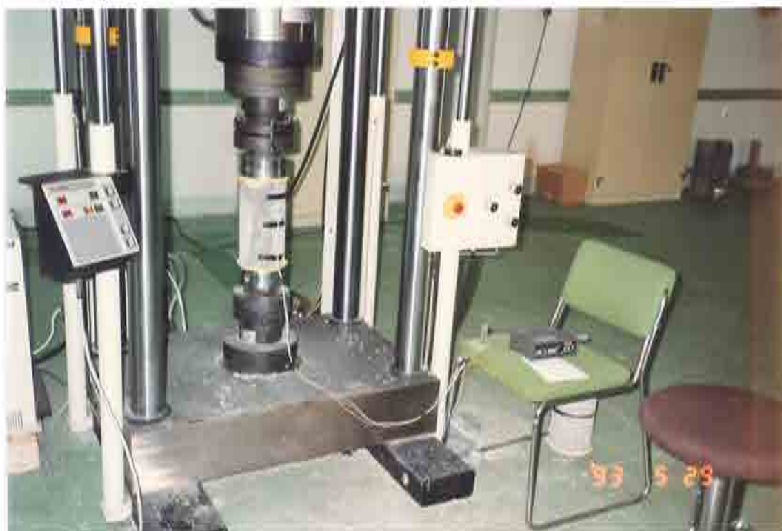
Figura 5.1.- Probeta sometida a un ensayo a fatiga.
