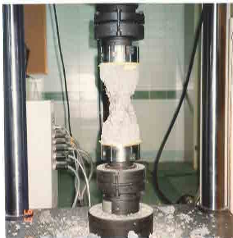
Figura 5.2.- Probeta rota tras ser sometida a un ensayo a fatiga.
