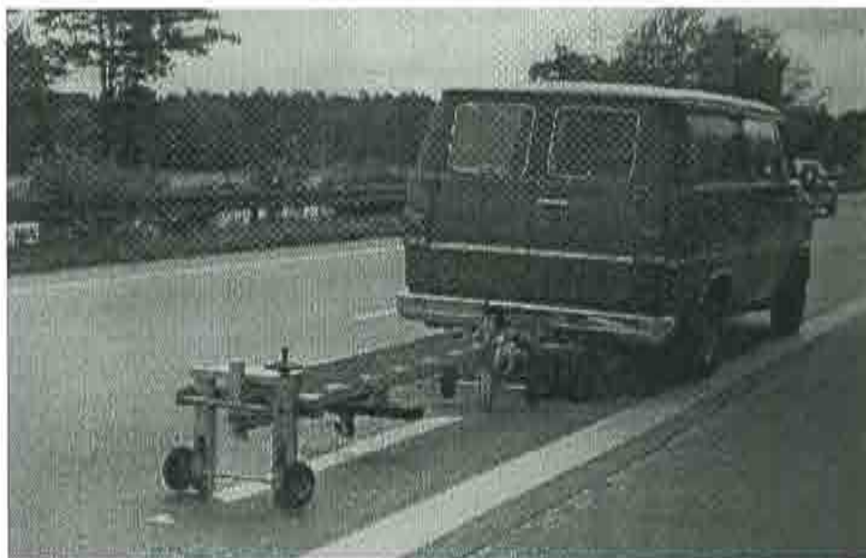
Figura A2.10.- Medición de la textura superficial.
