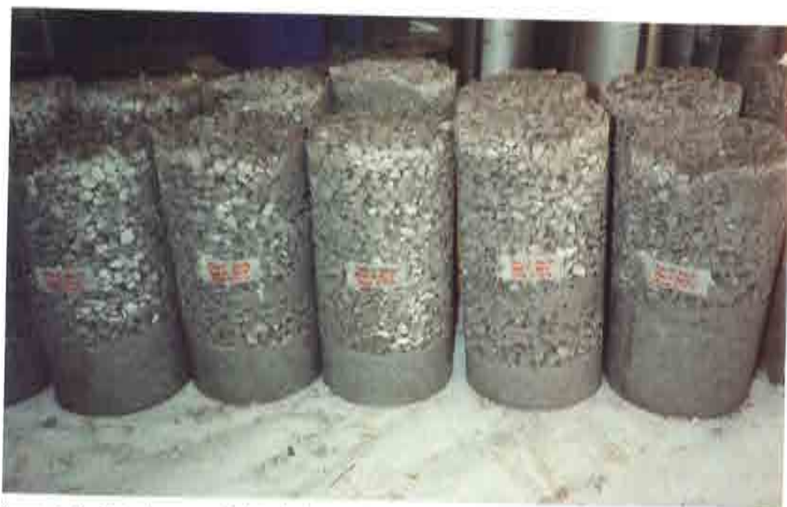
Figura 3.2.- Estado superficial de las probetas con elevado porcentaje de polímero.
