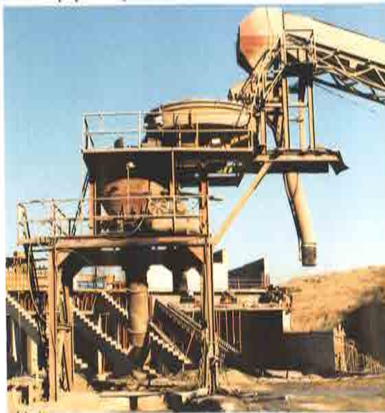
Figura 4.4.- Vista de la amasadora empleada en la fabricación del hormigón poroso.
