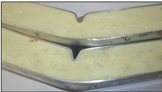
Figura 5. Perfiles reforzados con PUR y ensayados a flexión
