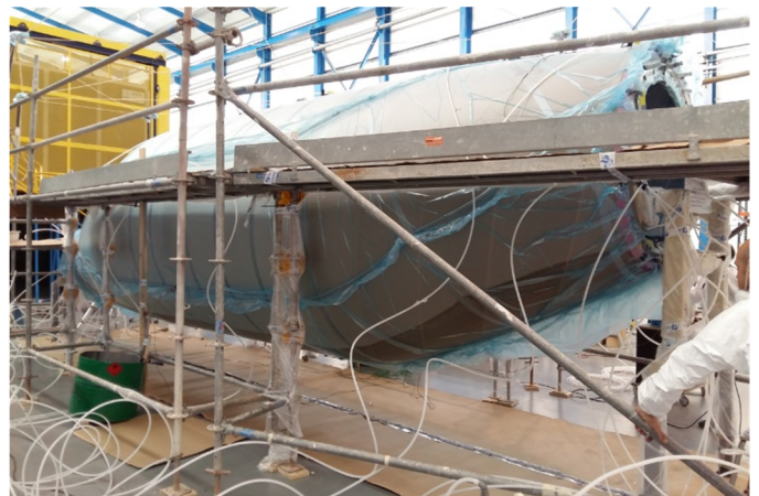
Figura 14. Infusión de resina en el demostrador
