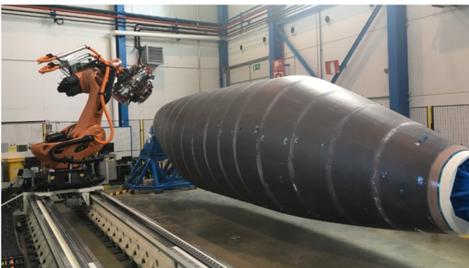
Figura 11. Estructura preparada para el revestimiento y robot de encintado
