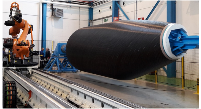
Figura 13. Aspecto final tras el encintado
