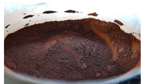
Figura 4.27. Una miscela di termite, utilizzando ossido di ferro.
