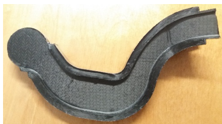
Figura 16. Pieza a neto desmoldeada del molde de RTM
