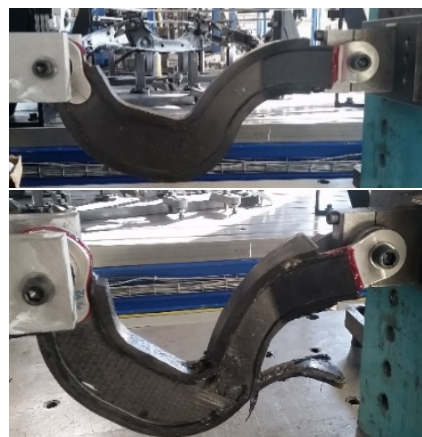
Figura 18- Componente en banco de ensayos y modo de rotura
