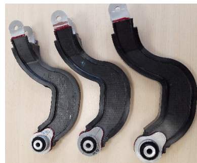
Figura 17. Piezas con los insertos metálicos integrados mediante unión adhesiva
