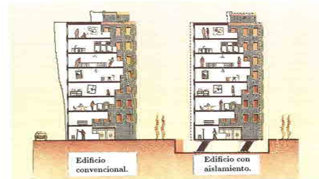
Figura 1.3 Comparación entre los comportamientos dinámicos de un edificio convencional y de un edificio con aislamiento antisísmico.
