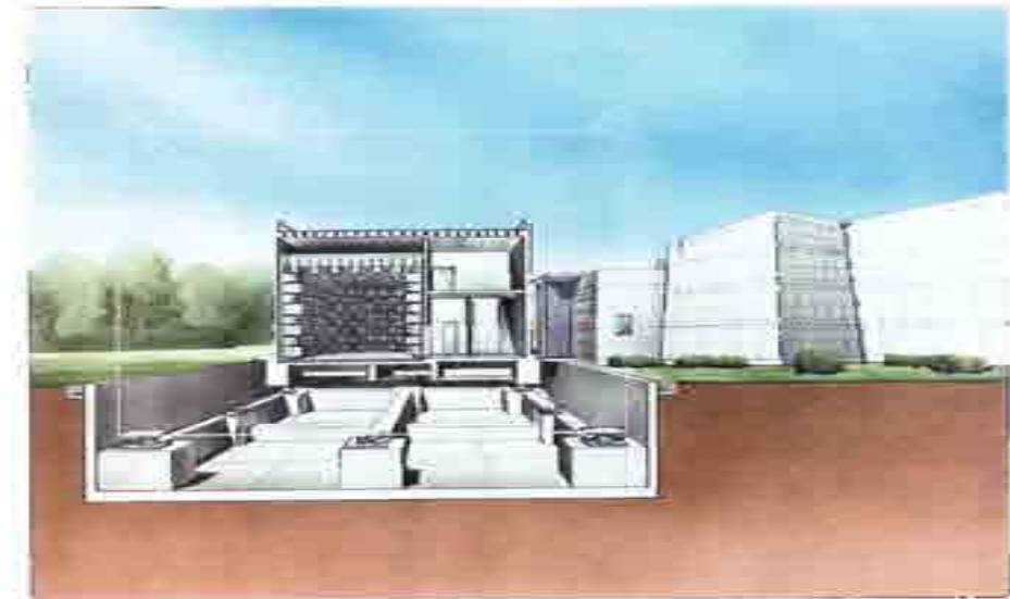
Figura 1.2 Representación esquemática de la disposición de los aparatos de apoyo.
