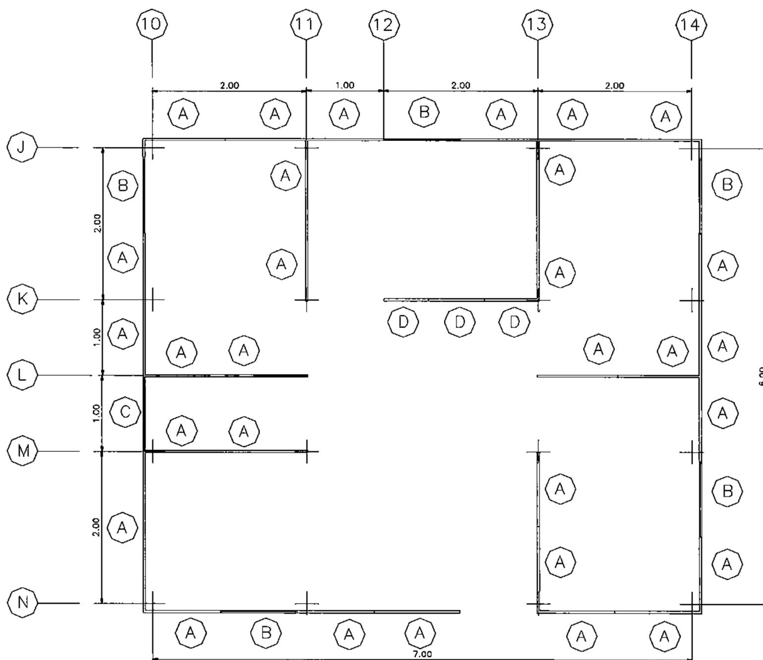
Figura 14. Planta estructural del sistema de resistencia sísmica.
