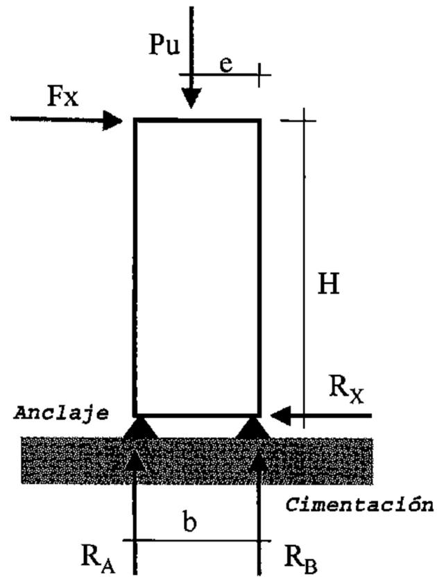
Figura 15. Reacciones del elemento estructural.
