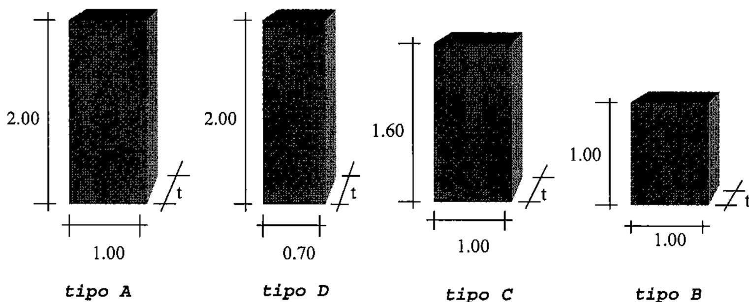
Figura 13. Elementos estructurales típicos en ferrocemento.
