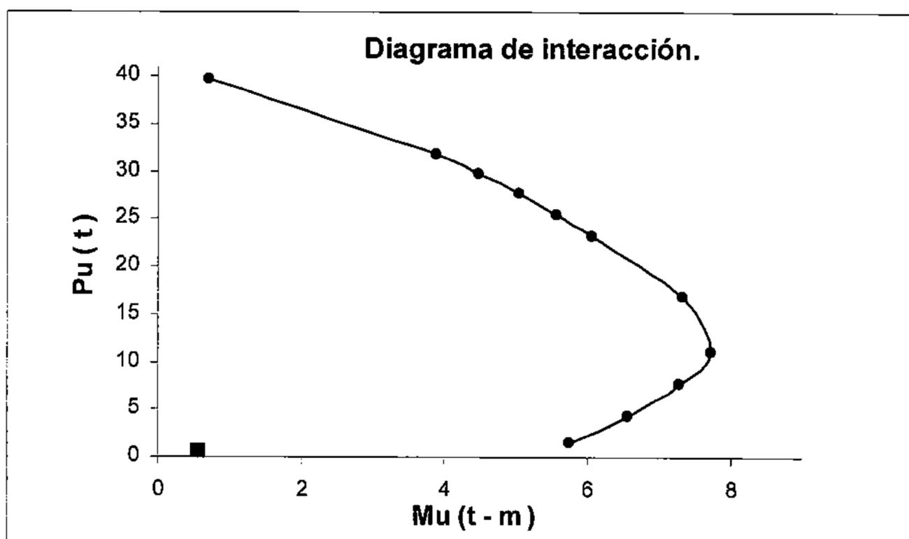
Figura 20. Diagrama de interacción para una sección de ferrocemento.
