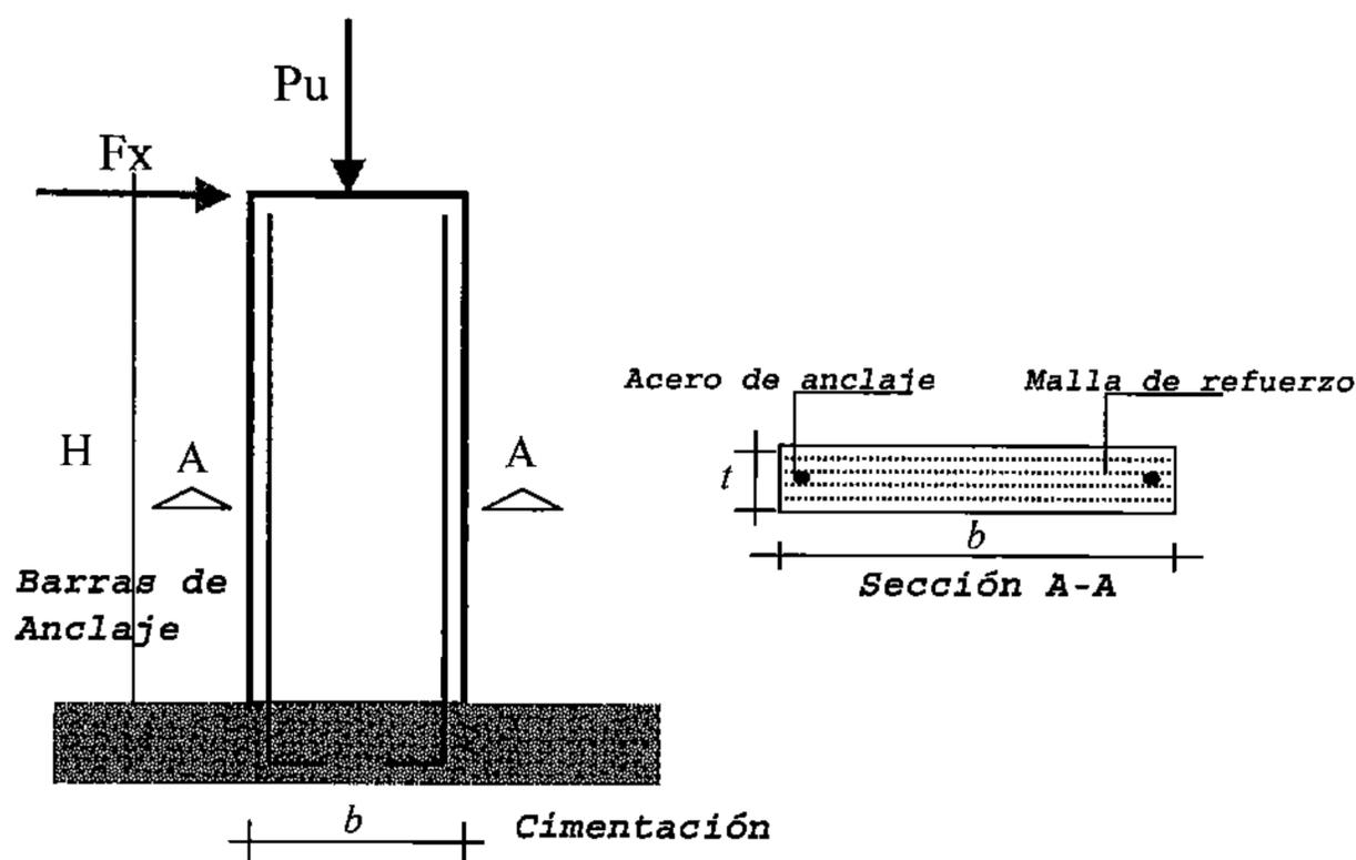
Figura 18. Refuerzo longitudinal del elemento estructural.
