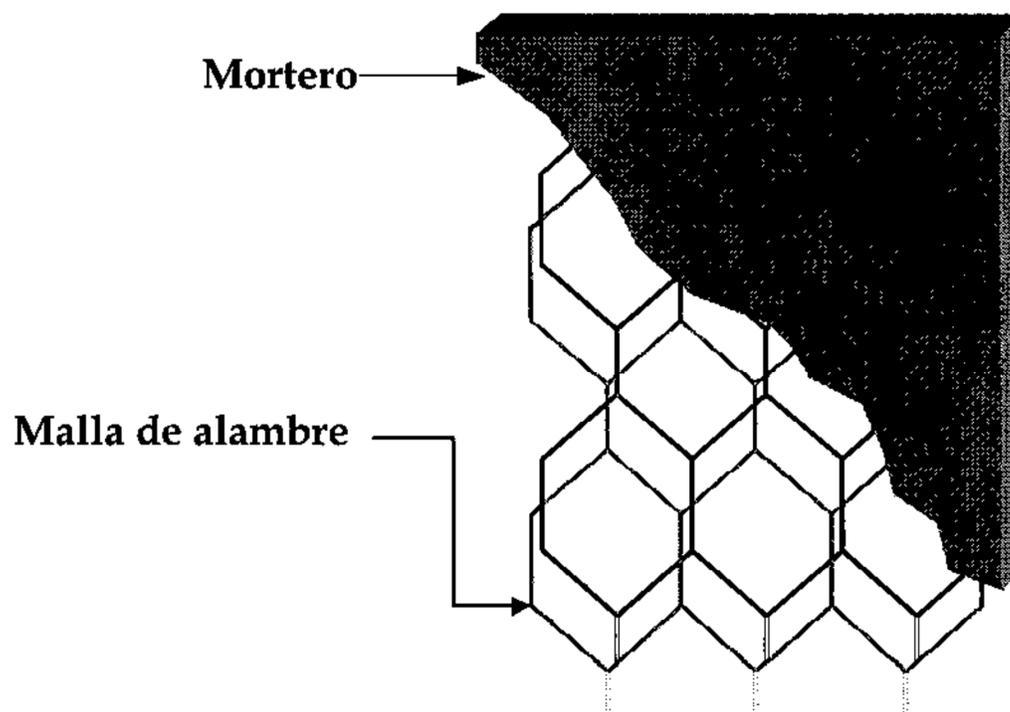
Figura 1. Sección típica de ferrocemento. [Farbiarz 2001].
