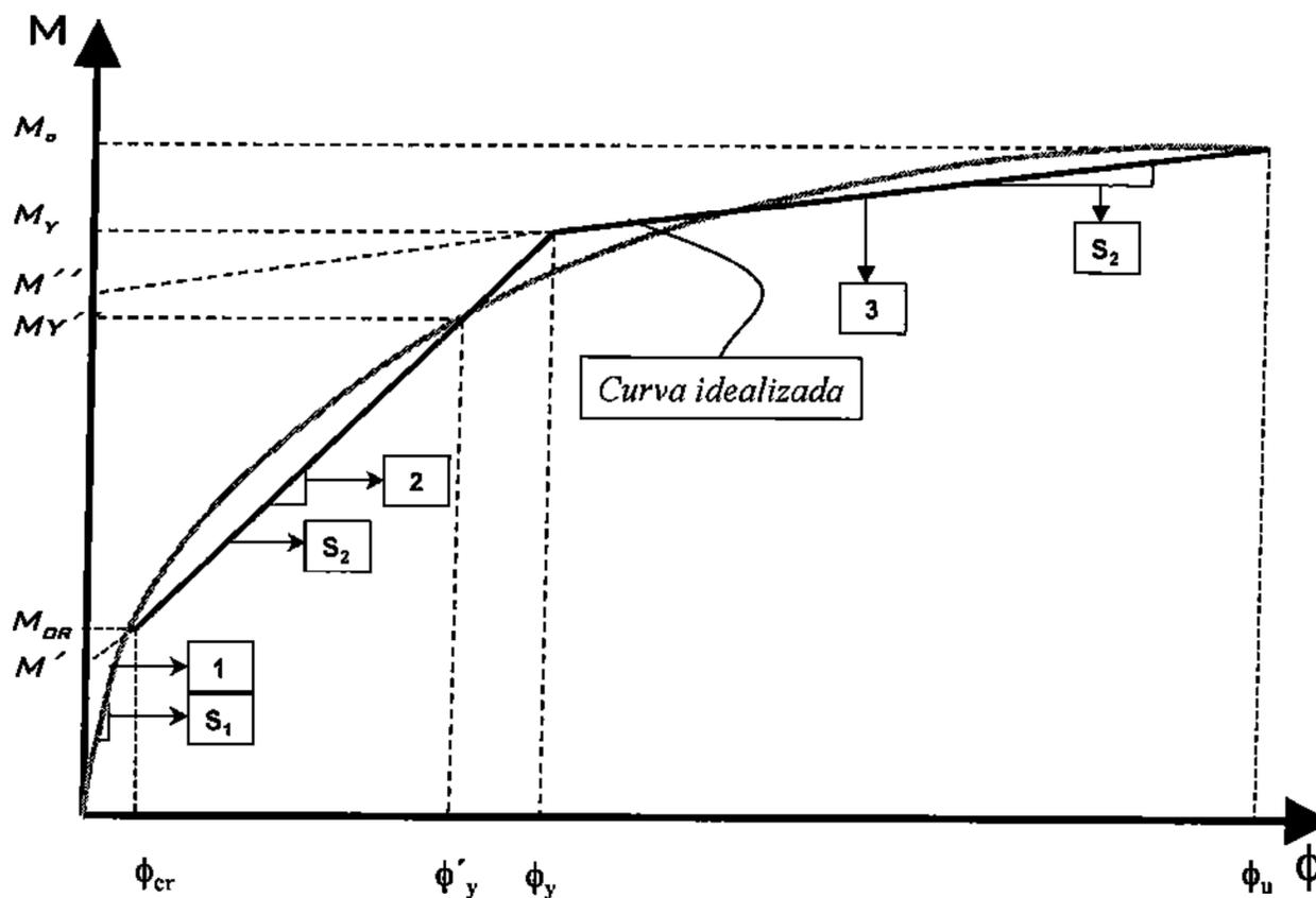
Figura 10. Diagrama idealizado de momento Curvatura. ( $M - \phi$ ).
