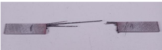
Imagen 16: Probeta post ensayo T-D-RT
