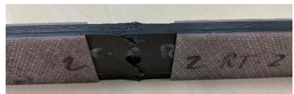
Imagen 11: Probeta post ensayo OHC-A-RT
