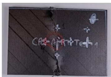
Imagen 12: Probeta post ensayo CAI-A-RT
