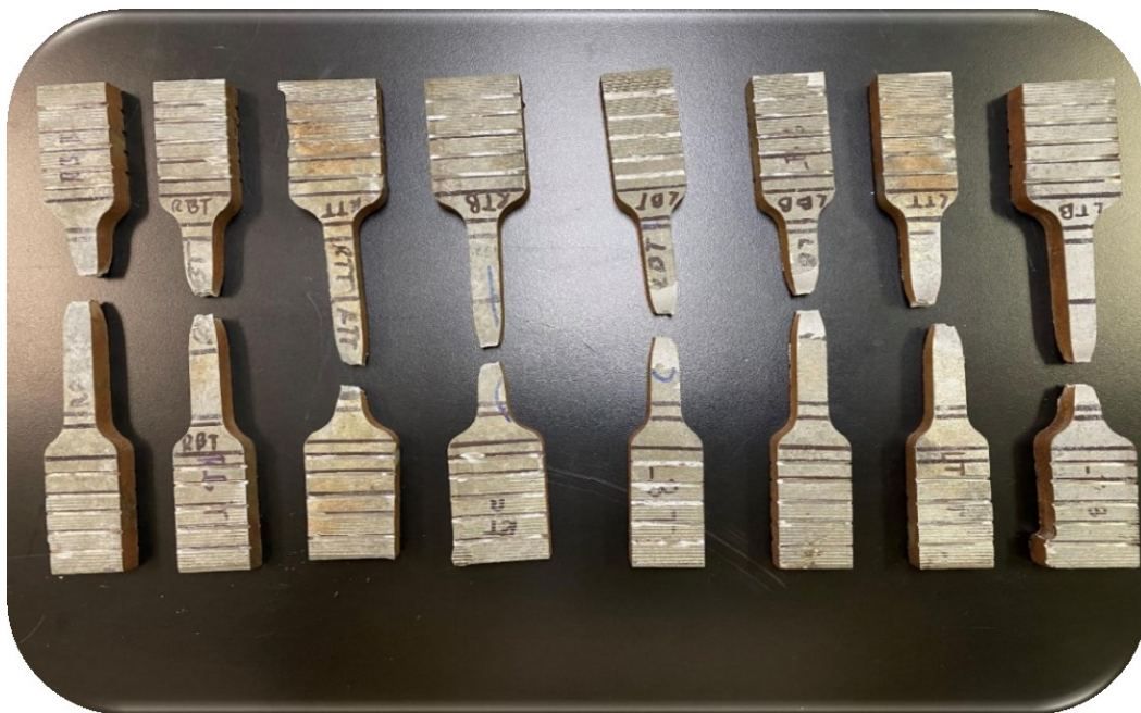
Figura 16: Probetas del ejemplo 1 luego de ensayadas.
