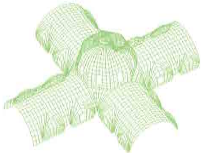
Fig. 11.1 Cubierta del Sagrario (Análisis a peso propio)
