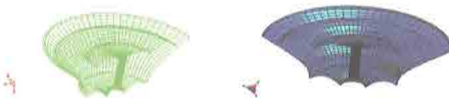
Fig. 2.1 * Hiperboloide de Revolución (Torroja) Tanque elevado de agua
