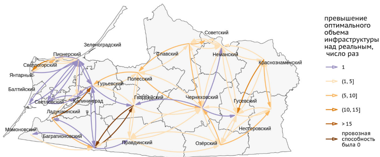
Рис. 32. Оптимальный объем провозной способности в сценарии, в котором транспортную сеть можно только расширять, но так, что суммарная величина новых инвестиций не превышает более чем в 1,5 раза восстановительную стоимость действующей сети дорог
