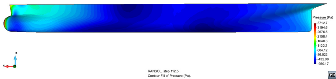
Figura 5.40. Distribución de presiones en el casco a 5 nudos (Fuente: Tdyn).
