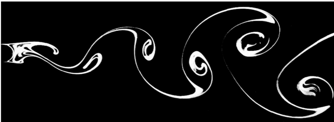
Figura 5.10. Formación de vórtices de Von Karman en un cilindro sumergido (Fuente: http://waiwhakaiho.org.nz/wp-content/uploads/2014/12/05KarmanVortexStreets.jpg ).
