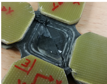
Figura 3. Detalle de la región central de una probeta cruciforme con laminado [\pm 45]_s tras el ensayo biaxial T-C.
