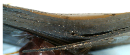
Figura 4. Probeta con laminado [\pm 33.7]_{2s} ensayada a flexión de tres puntos.
