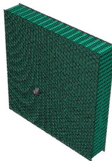
Figura 1. Modelo de elementos finitos de la estructura sándwich y el proyectil.
