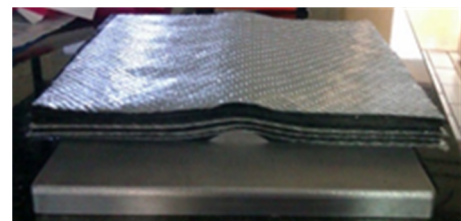
Figura 1: Útil de aluminio utilizado para la fabricación de las probetas con la mitad de las capas apiladas sobre él antes del curado. Se puede apreciar como las capas no se ajustan totalmente a la geometría del útil.
