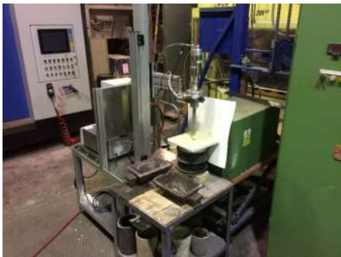
Figura 1: Disposición de la sonda y convertidor ultrasónicos sobre el crisol conteniendo el material nanorreforzado situado en el horno de inducción.
